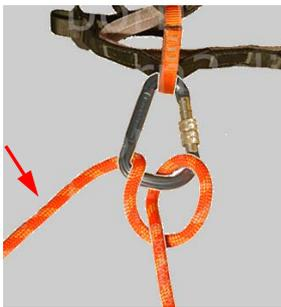
Wird der Halbmastwurf in einen Karabinerhaken eingelegt, ist darauf zu achten, dass das unbelastete Seilende (Pfeil) nicht auf der Verschlussseite des Karabinerhakens liegt.
