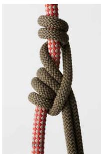
Der Prusik ist ein sog. Klemmknoten, der sich im lastlosen Zustand auf dem Seil verschieben lässt und erst bei Belastung festklemmt.
